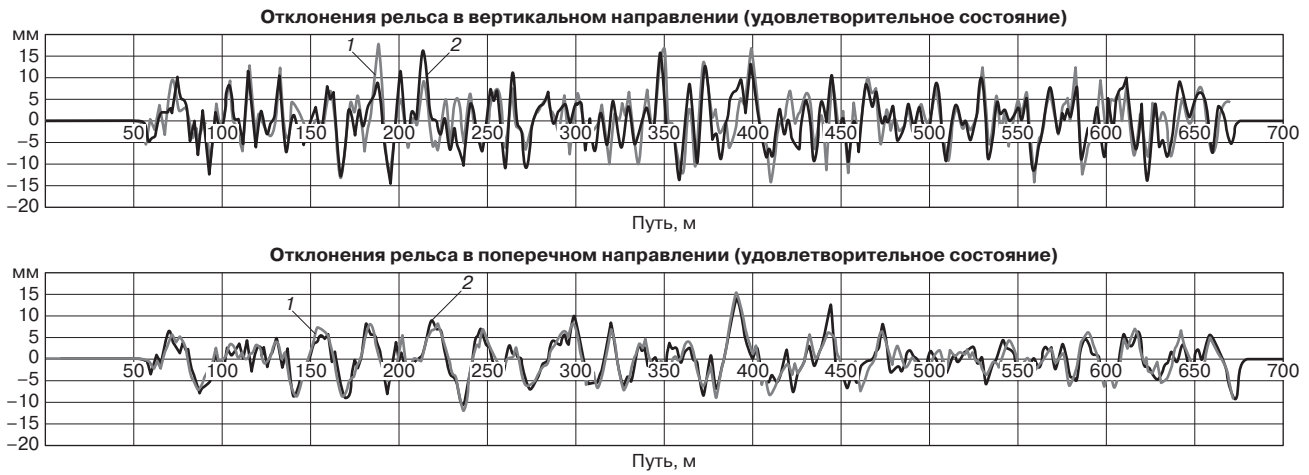
Рис. 6. Неровности пути, применяемые при моделировании: 1 — левый рельс; 2 — правый рельс Fig. 6. Rail deteriorations, used for modelling: 1 — left rail; 2 — right rail
