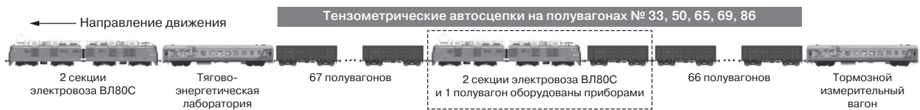
Рис. 1. Схема опытного поезда массой 12600 т Fig. 1. Composition of tested train of 12600 tonnes
