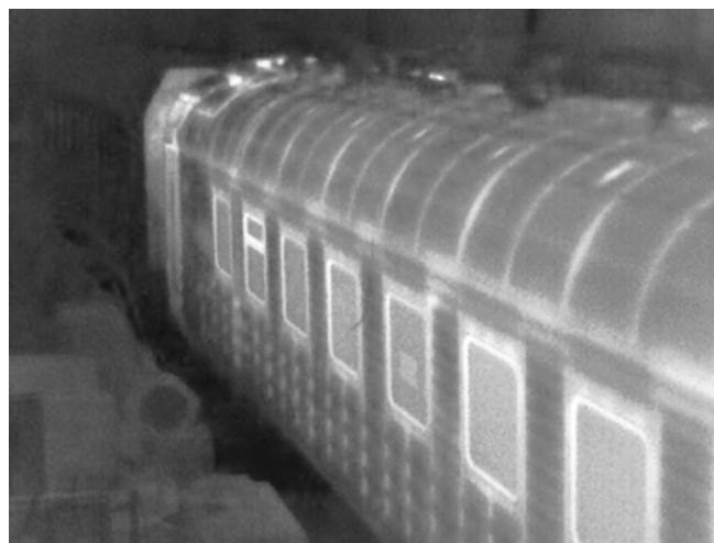
Рис. 1. Обследование кузова пассажирского вагона тепловизором при определении среднего коэффициента теплопередачи Fig. 1. Inspection of passenger car body with infrared imager for determination of the average heat transfer coefficient
